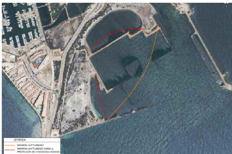
Ilustración 90. Ubicación barrera antiturbidez retirada tablestacas terrestres
