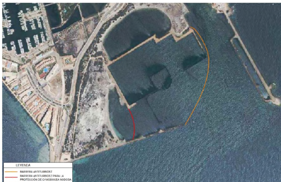
Ilustración 89. Barrera antiturbidez retirada tablestacado marítimo
